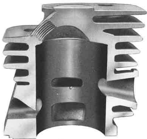
Bild 3: Überströmkanalkante zerstört.
