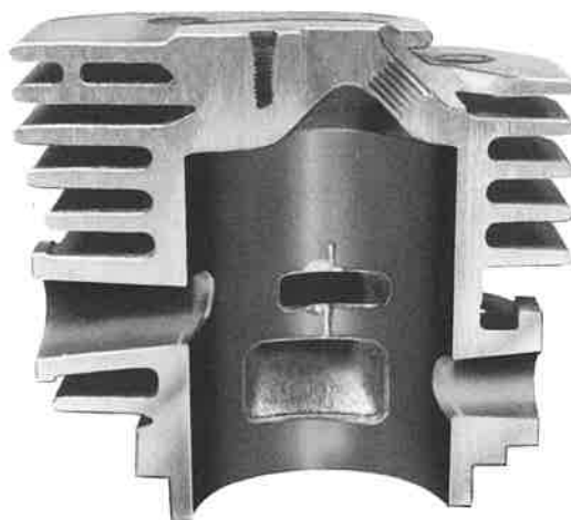
Bild 4: Typisches Beispiel für starke Beschädigung der Zylinderlaufbahn in Form einer tiefen Rille. Gleichzeitig Überströmkanalkante zerstört.
