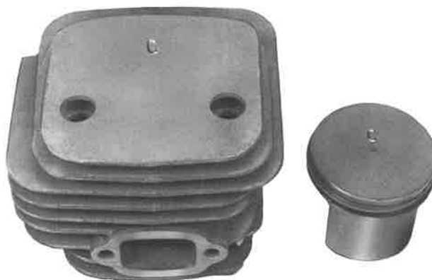
Bild 1: Maßgruppen-Kennbuchstaben am Zylinderflansch und auf dem Kolbenboden, in diesem Fall Gruppe »C«.
