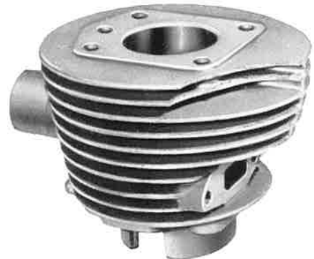
Bild 5: Beschädigung des Zylinders durch einen doppelten Rippenbruch.
