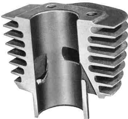
Bild 3: Überströmkanalkante zerstört.
